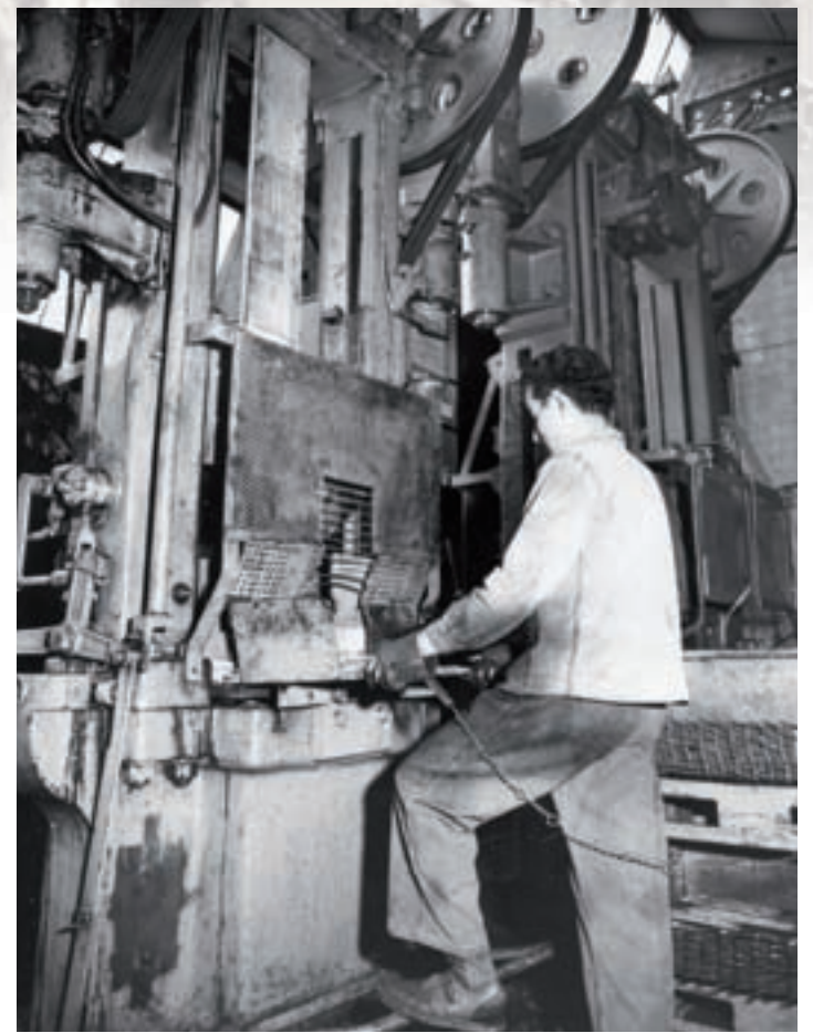
Ici, l'ouvrier travaille avec des "menottes" reliées à une chaîne, qui retiennent ses mouvements, lui évitant de se blesser sous la presse.
