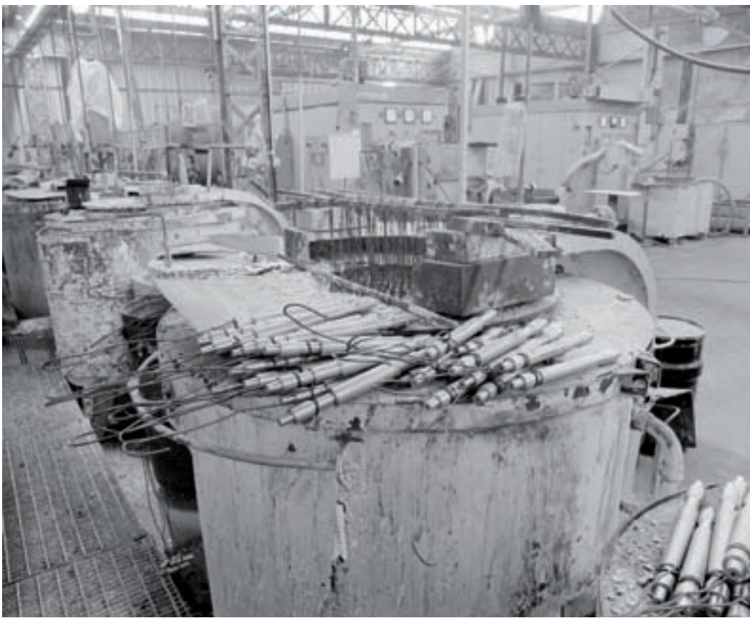
Cuves pour bains de cyanure métallique, trempage de l'acier.
